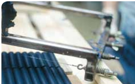
Drahtbespannter Rahmen zum Schneiden der Pastelle Wire-strung frame for cutting the pastels
